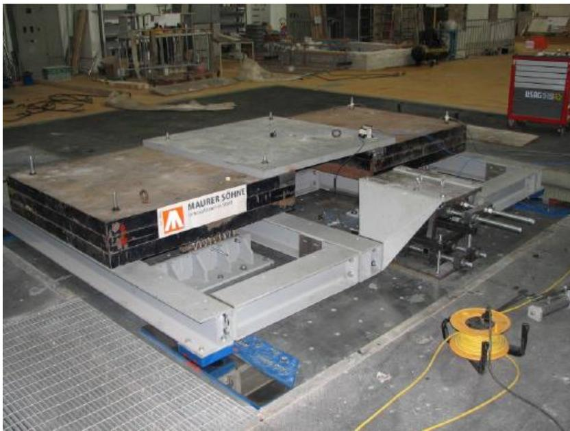
Abb. 11.20: Versuchsaufbau für Rütteltischprüfungen
