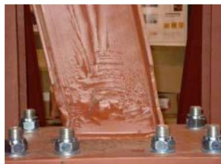
Abb. 3.8: Beispielhaftes hysteretisches Verhalten und Schadensbild für monotone Belastung
