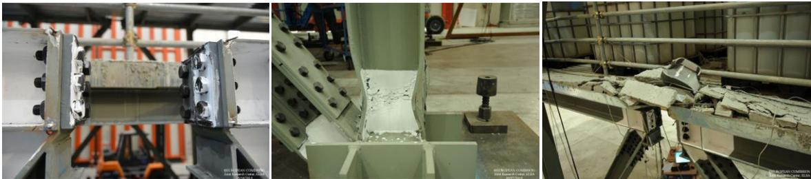
Abb. 7.7: Zustand des Prüfkörpers nach dem letzten Versuch [3]
