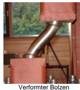
Abb. 4.7: Last-Verschiebungs-Kurven und verformte Prüfkörper unter monotoner Belastung
