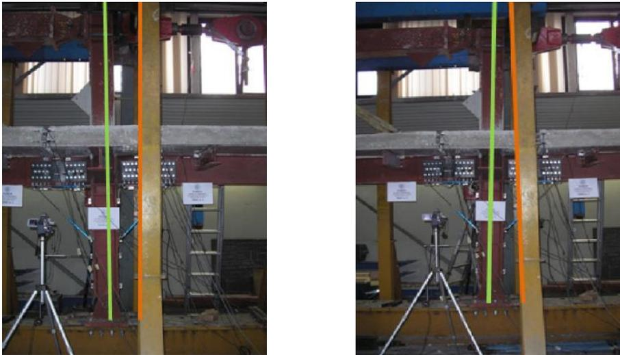
Abb. 5.8: Verformungsfigur des Rahmens und Belastung in a) -X-Richtung und b) +X-Richtung
