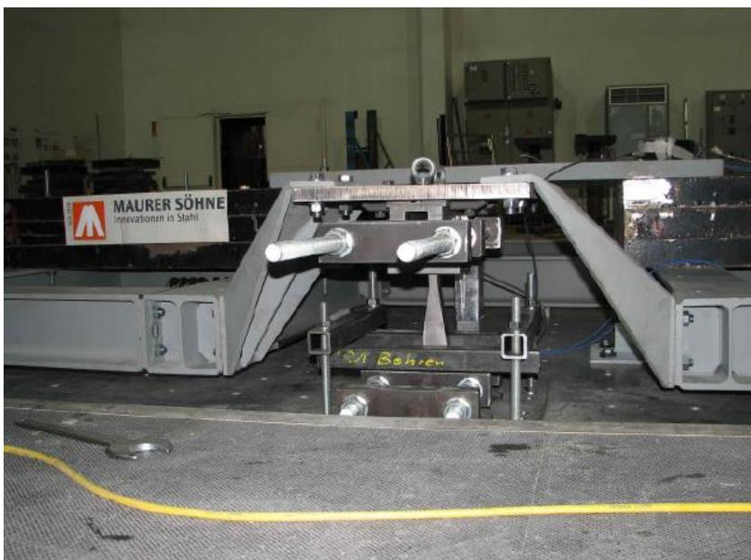
Abb. 11.21: Detail des Stahlrahmens mit dem TRSH-Element und dessen Verankerungssystem
