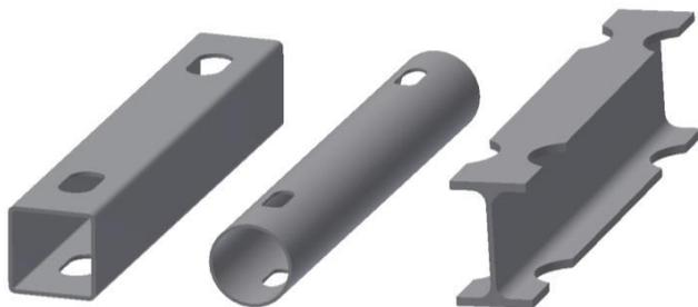
Abb. 3.4: Verschiedene Profile für FUSEIS Trägerverbinder mit geschwächtem Querschnitt (RBS): RHS oder SHS, CHS und IPE- oder HEA-Profile
