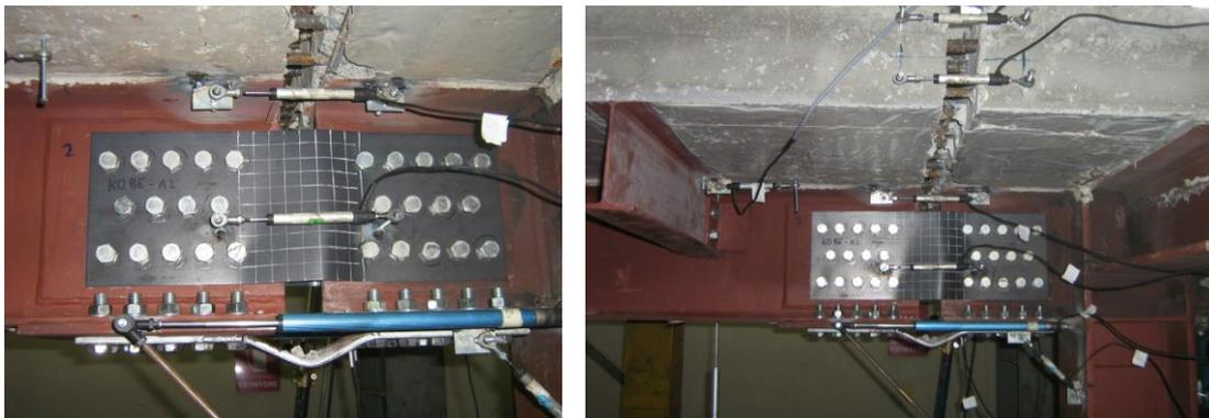
Abb. 5.15: Versagensmechanismus während experimenteller Versuche
