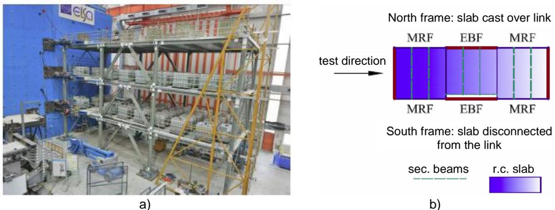
Abb. 7.5: Die Prüfkörper: a) 3D-Ansicht; b) Grundriss [3].
