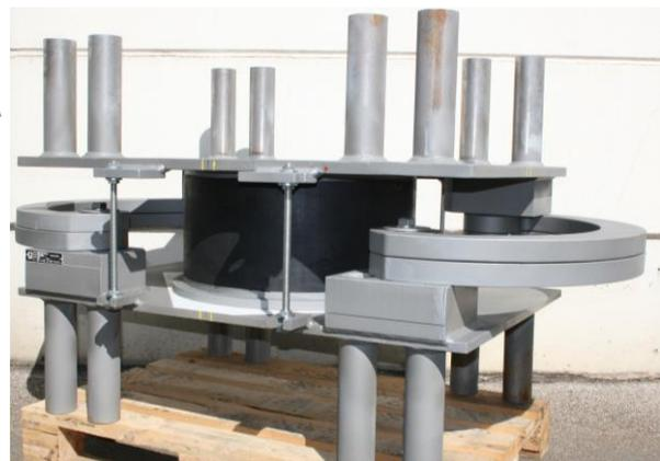
Abb. 12.2: Mondförmige hysteretische Stahlvorrichtungen kombiniert mit einem Bleikernlager als Isolationseinheit
