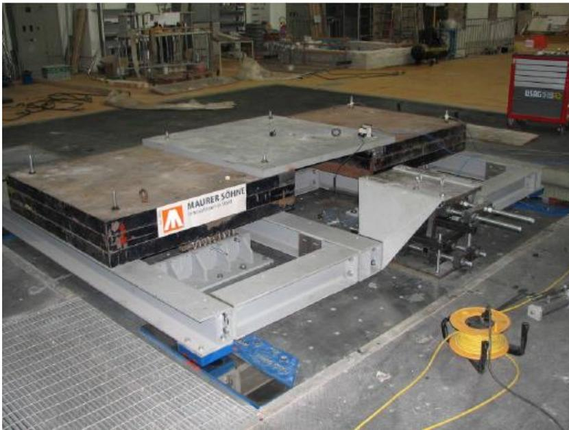
Figure. 11.19: Maquette d'essai pour les tests sur table vibrante
