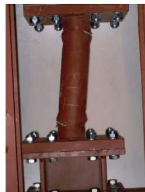
Figure 3.9: Exemple de comportement hystérétique et de mode de ruine pour joints en H et tubulaires
