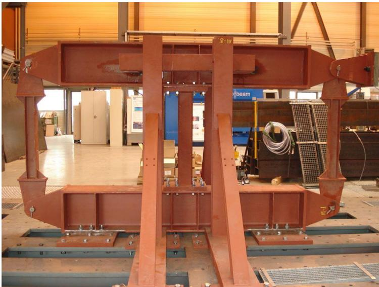
Figure 3.7: Photo du montage avec éléments de stabilisation transversaux
