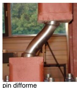
Figure. 4.7: Courbes charge-déplacement et spécimens déformés sous charges monotones
