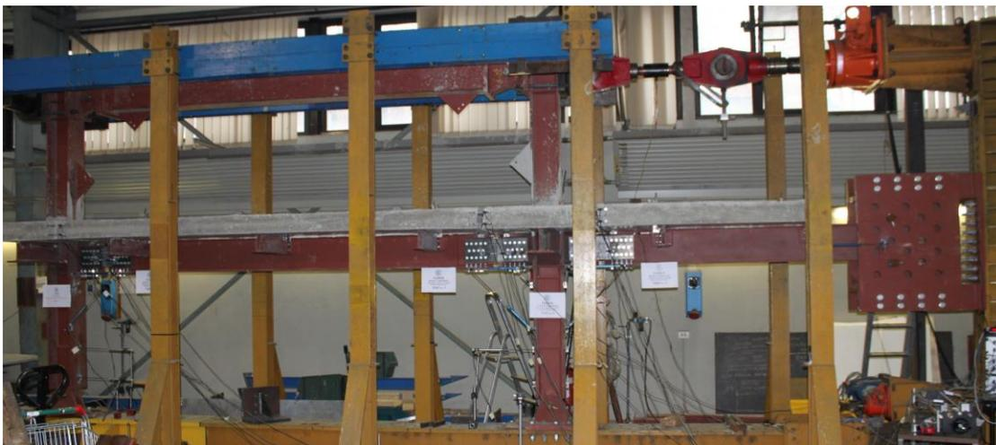
Figure. 5.7: Montage de test du portique
