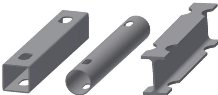
Fig. 6.10: Zones dissipatives des poutres FUSEIS en utilisant des poutres à section réduite (RBS)
