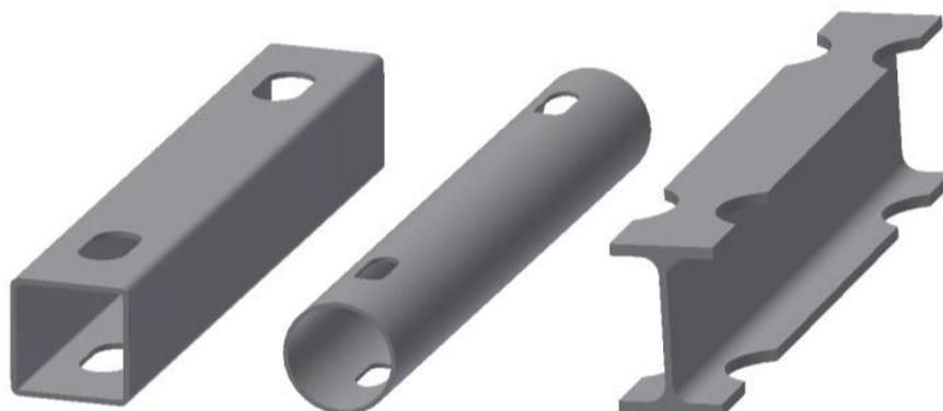
Fig. 6.10: Zone dissipative nelle travi del Sistema FUSEIS, usando sezioni ridotte.
