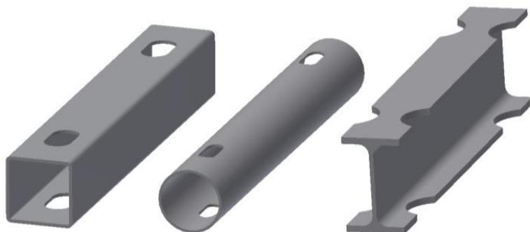
**Fig. 6.10: Zonas dissipativas nos ligadores de vigas FUSEIS utilizando secções reduzidas de vigas (RBS)**
