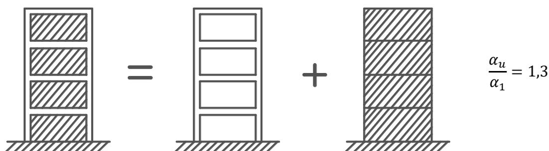
Fig. 6.11: Pórticos MRF combinadas com painéis de corte em aço (zonas dissipativas nos painéis fletores e de corte). Valores predefinidos para  $\alpha_u/\alpha_1$  (consultar 6.3.2(3) e a Tabela 6.2).
